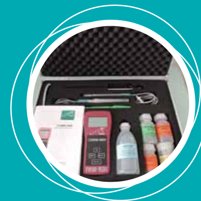
Измерительный прибор COMBI 5000 (измерение кислотности, температуры, влажности почвы)
