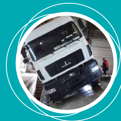
Испытания на стенде опрокидывания по оценке поперечной статической устойчивости
